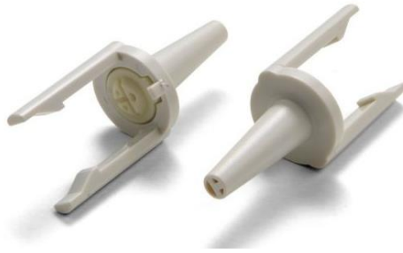
Slika 3 - koničan nastavak sonde od aparata za ispitivanje oštećenja sluha
