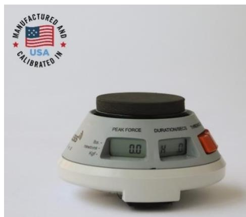
Slika 6. Standardni ručni dinamometar tipa *push*
