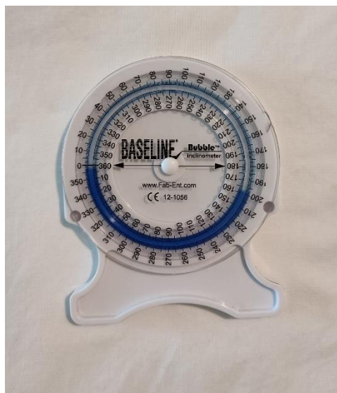
Slika 2. Prikaz gravitacijskog kutomjera
