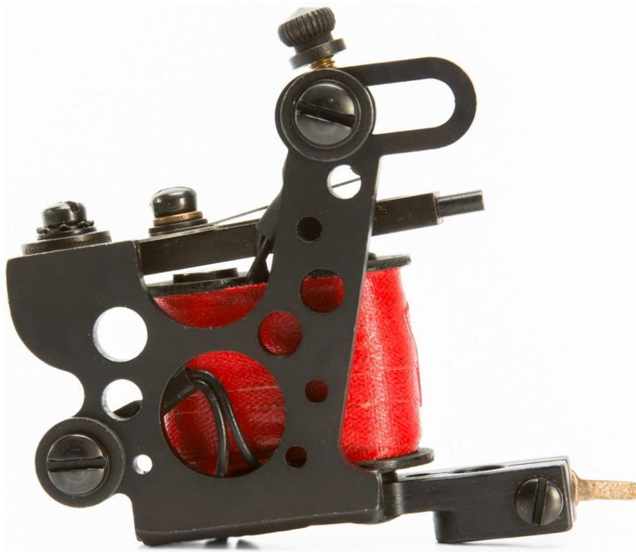
Slika 4 Stroj za tetoviranje s zavojnicom
