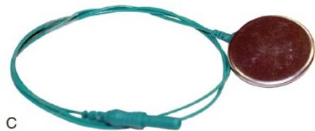
Slika 7. Elektroda za uzemljenje za ENG
