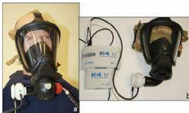
Slika 1. Prikaz Cosmed K4b uređaja za mjerenje tjelesne aktivnosti
