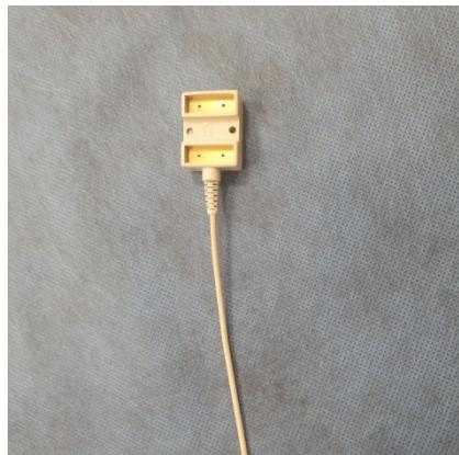
*Slika 2. Registracijska površinska elektroda*
