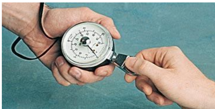
Slika 5. Dinamometar za mjerenje snage pincetnog hvata (od engl. Pinch dynamometer)
