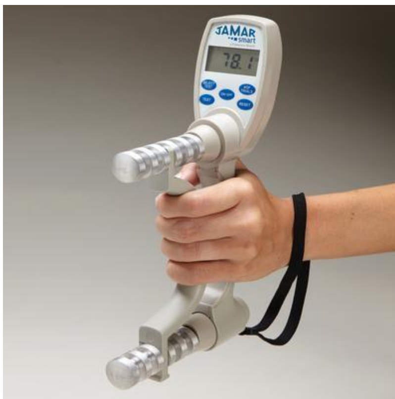
Slika 7. Mjerenje snage stiska šake dinamometrom
