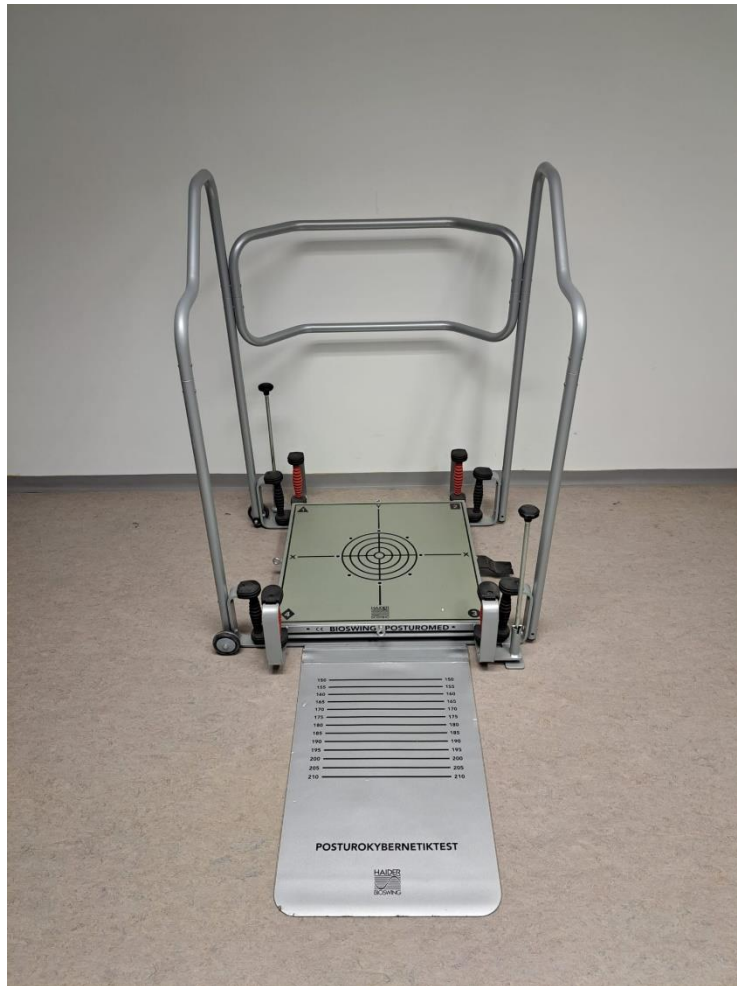
Slika 6. Posturomed uređaj Izvor: osobni izvor
