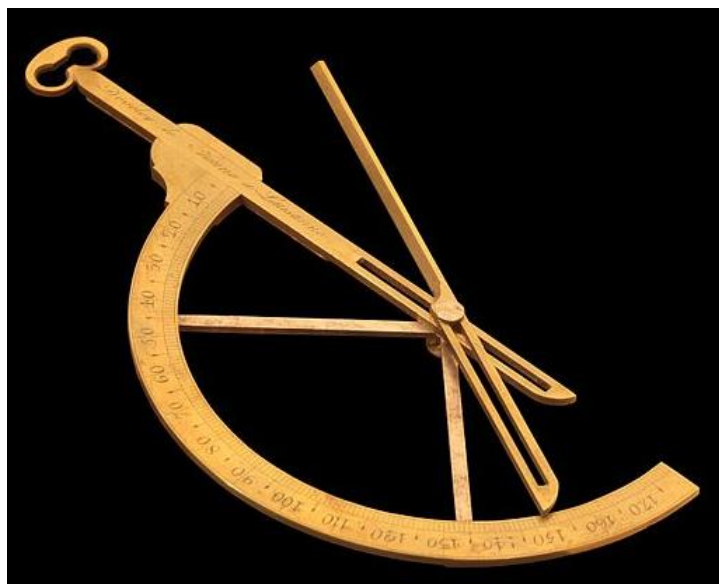
Slika 7. Klasični dvokraki goniometar s polukružnom skalom
