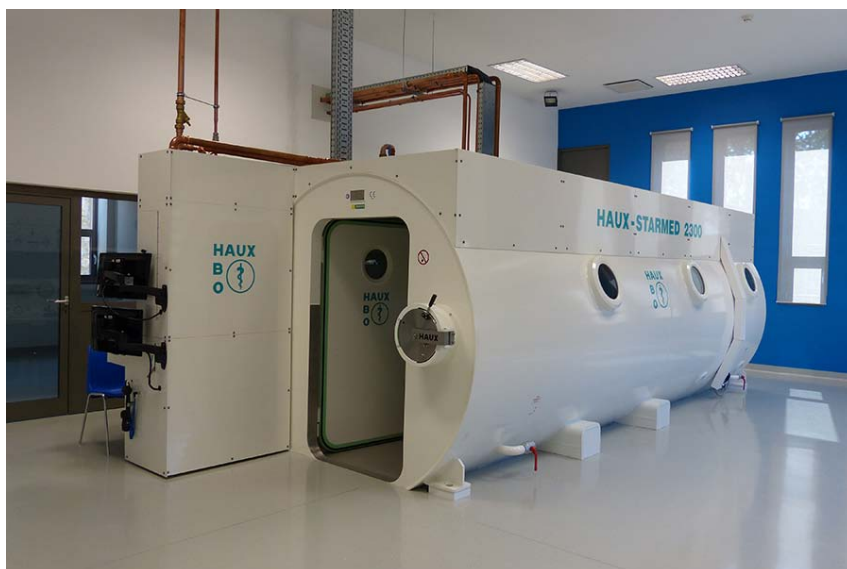
Slika 4.2. Prikaz višemjesne dvoosječne hiperbarične komore
