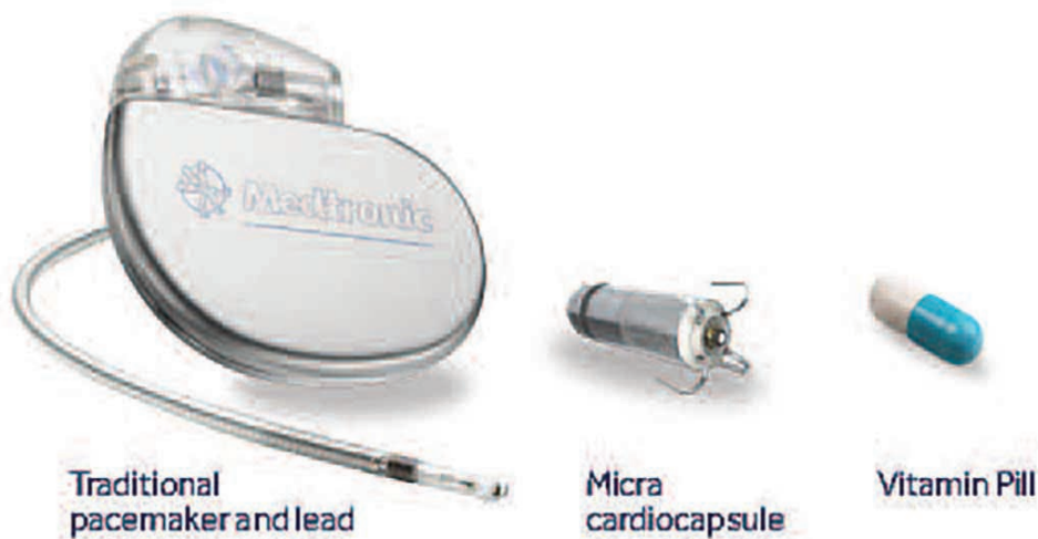
Slika 4: Usporedba MICRA elektrostimulatora sa tradicionalnim elektrostimulatorima i kapsulom vitamina, Izvor: Meet Micra, Medtronic, 2016
