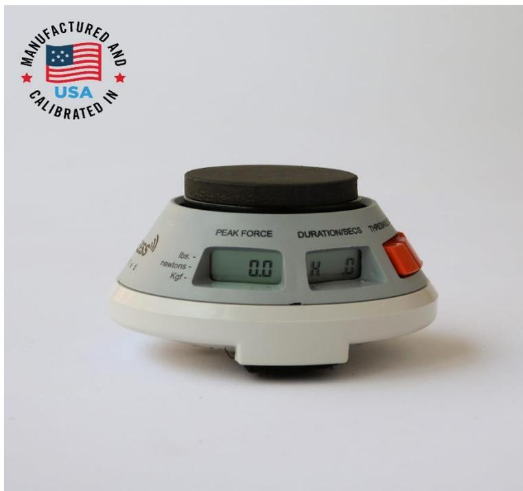
Slika 5. MicroFET®2 dinamometar
