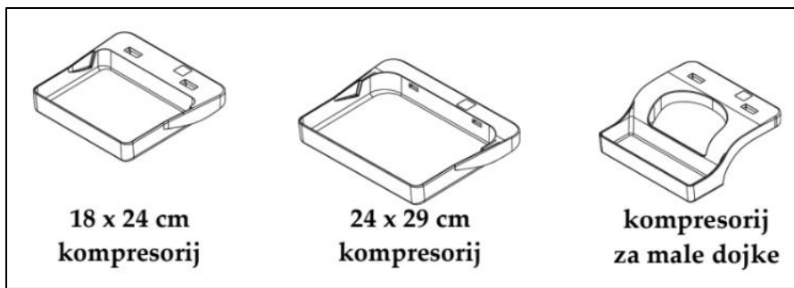
Slika 13 Prikaz skica rutinskih kompresora. Izvor: Selenia Dimensions Priručnik za korištenje
