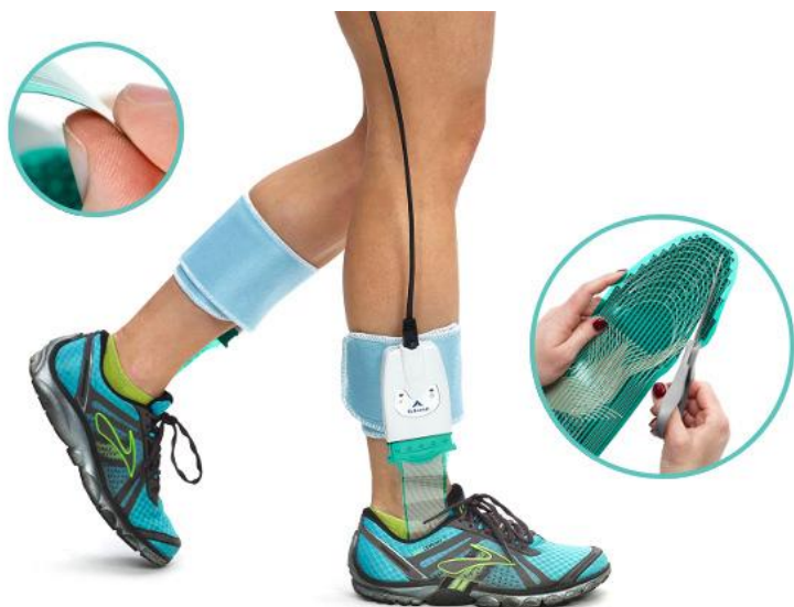
Slika 4.: Prikaz sustava pedobarografije u obliku uloška za cipelu
