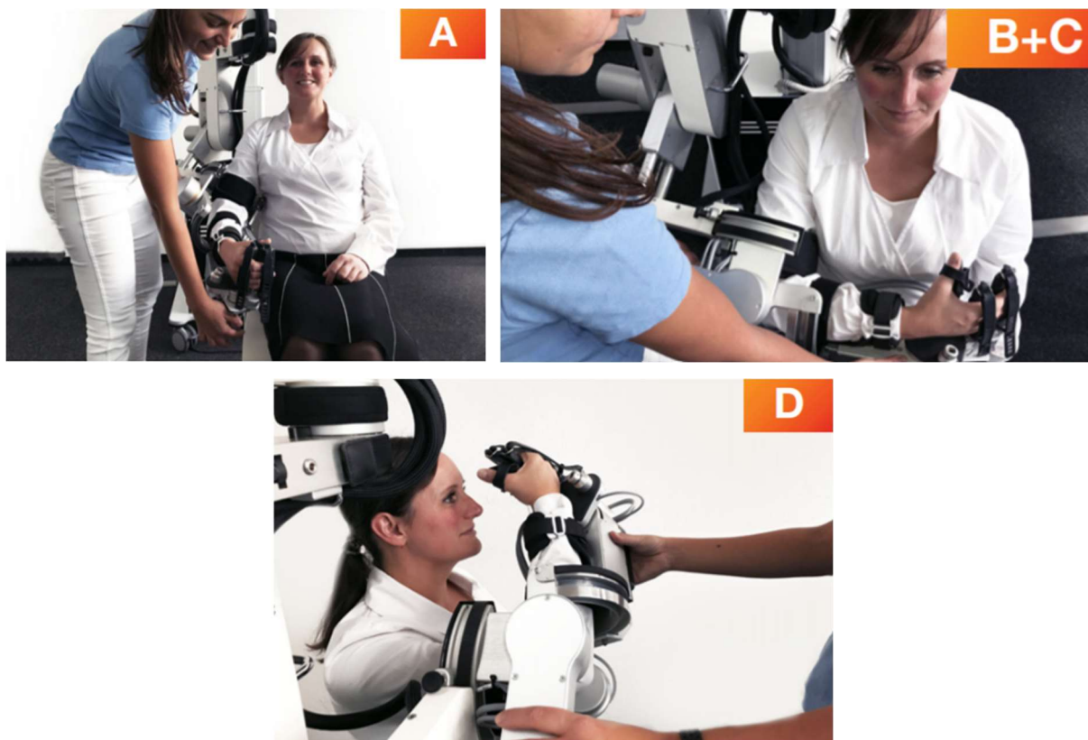
Slika 4. Postavljanje sigurnosnih zona prilikom postupka kalibracije
