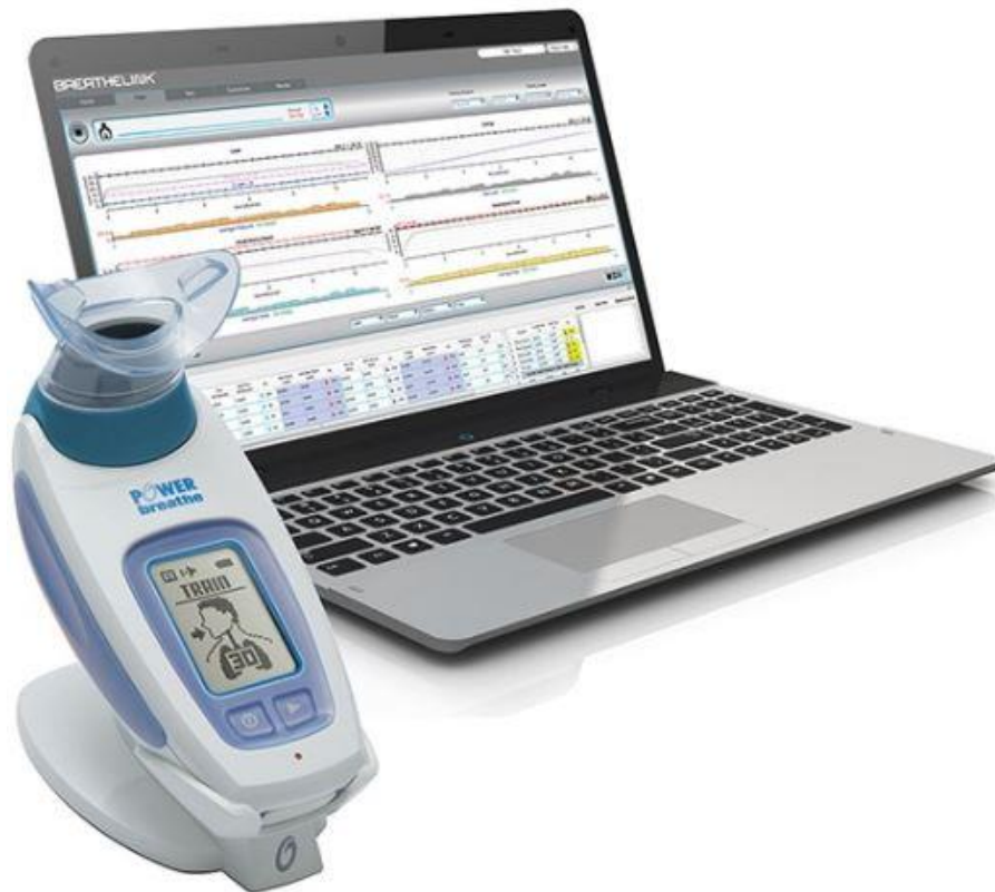
Slika 11. Uredaj za mjerenje maksimalnog udisajnog tlaka.
