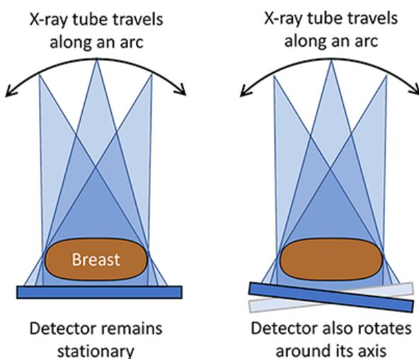
Slika 5. Rendgenska cijev i detektor kod tomosinteze, preuzeto 06.07.2023. s:
