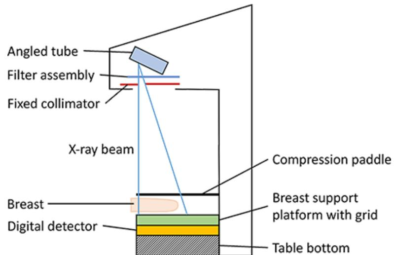
Slika 2. Dijelovi mamografskog uređaja, preuzeto 24. 06. 2023. s:
