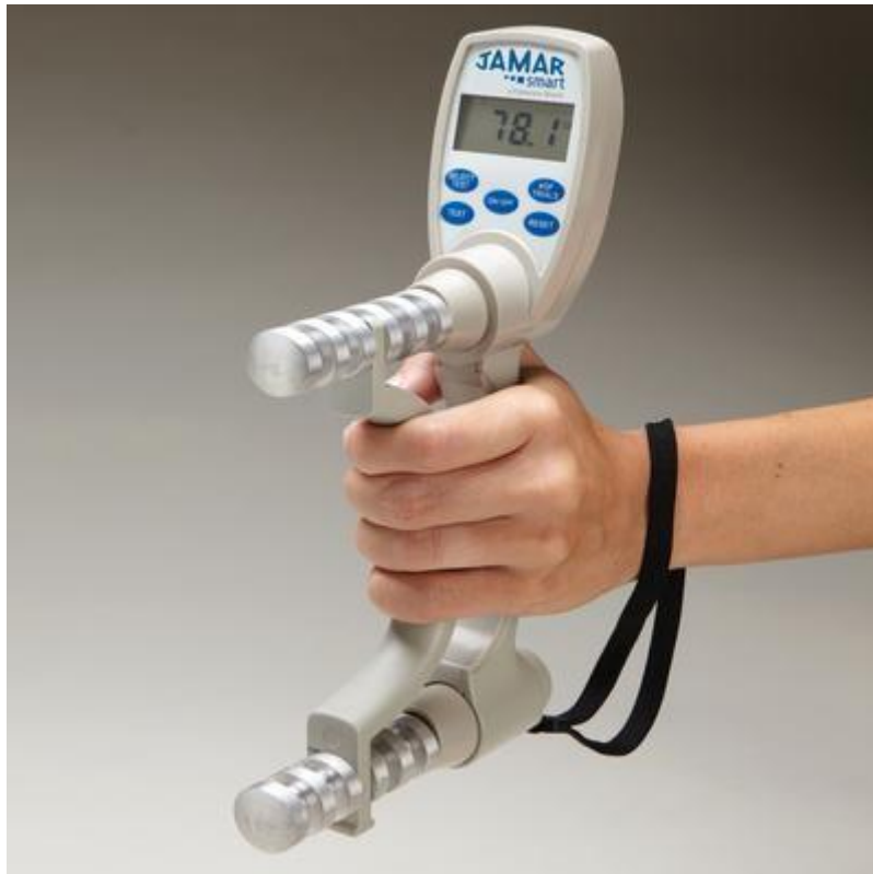
Slika 7. Mjerenje snage stiska šake dinamometrom
